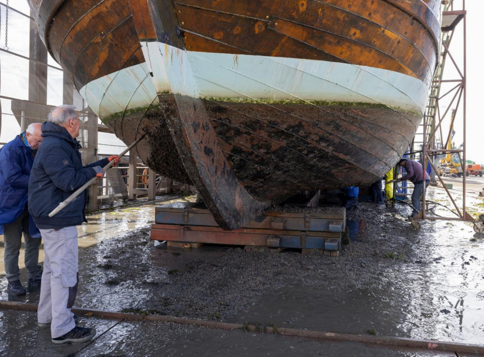
Knippen en scheren, pokken schrapen en aangroei wegsteken
